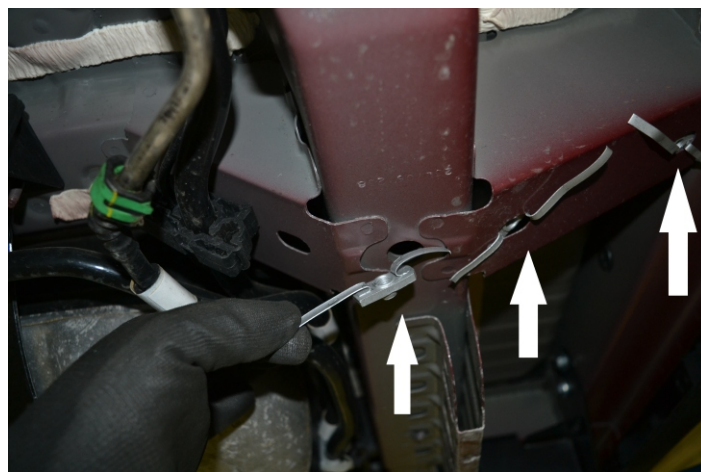
Рис. 2 - Установка закладных гаек в средней части автомобиля
