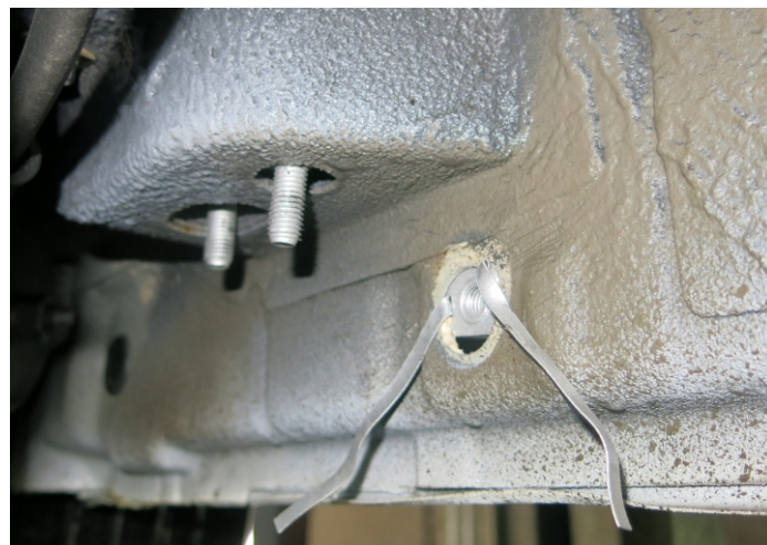
Рис. 2 - Установка закладных гаек и шпилек в средней части автомобиля
