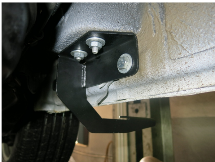
Рис. 4 - Установка заднего кронштейна
