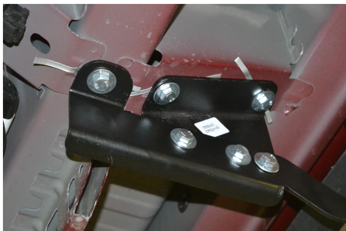
Рис. 5 - Установка опоры и кронштейна в средней части автомобиля
